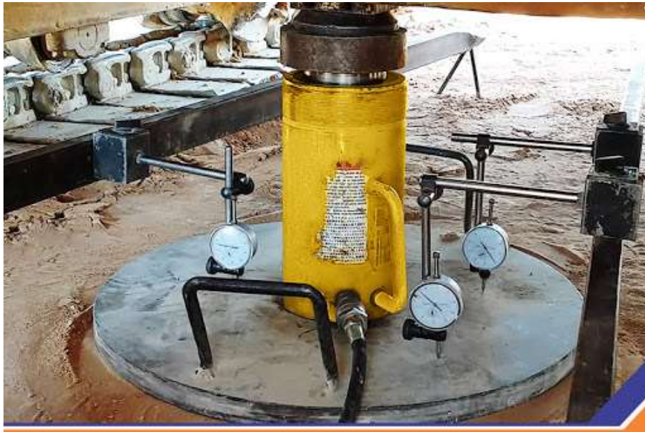
Figura 14: Representação de um ensaio de placa.
