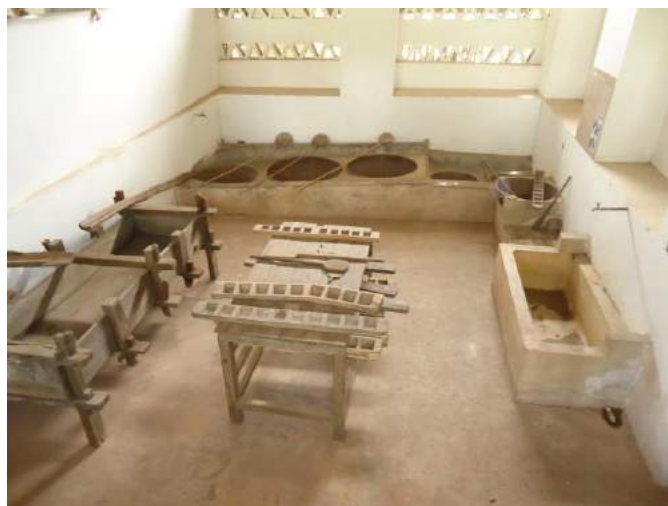
Figura 19 - Casa das caldeiras do antigo Engenho da Várzea (Areia - PB). Ao fundo as tachas de cobre para cozimento e evaporação do caldo. Ao centro, as fôrmas de madeira para a moldagem da rapadura.
