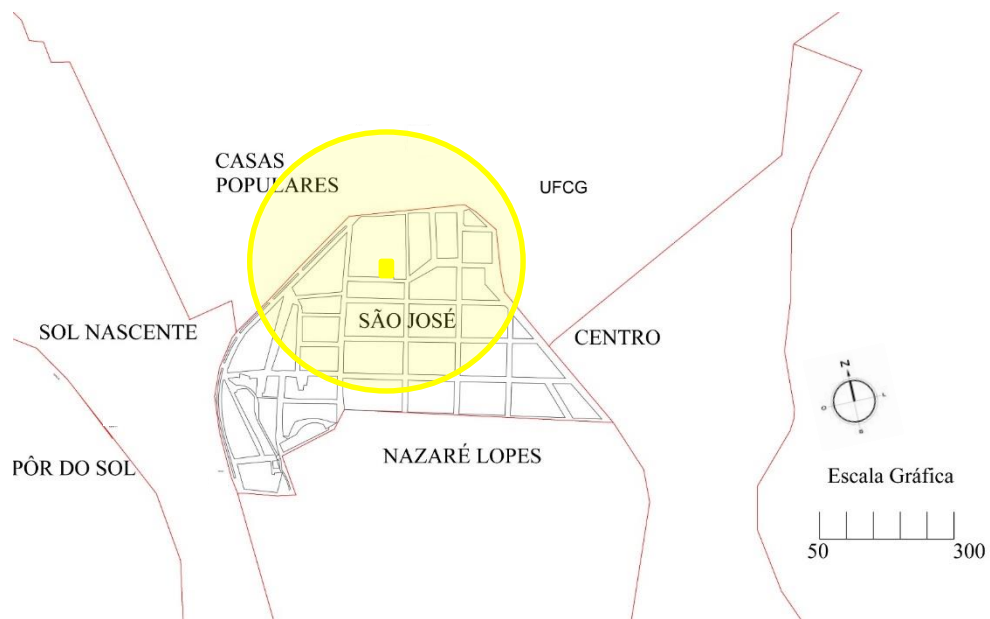
Imagem 22 – Raio de influência de equipamentos urbanos comunitários de educação: Creche e pré-escola (400m).
