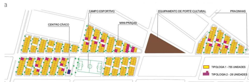
Figura 20: Esquema de implantação do projeto (Fonte: redearquitetos 2009)
