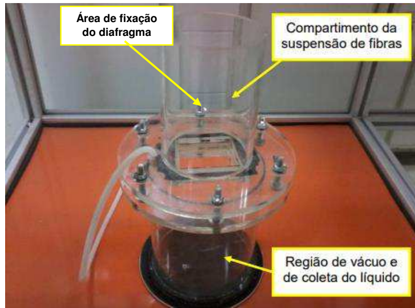
Figura 9: Sistema de deposição do diafragma sobre o cátodo (Adaptado de CUNHA, 2015).
