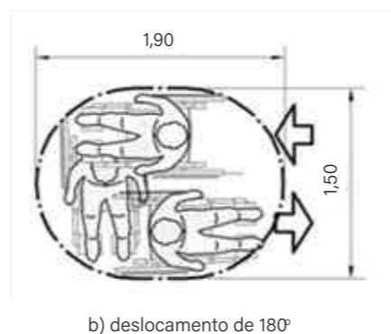
Figura 04: Dimensões mínimas para locomoção de cadeirante em movimento U. Fonte: Associação Brasileira de Normas Técnicas, NBR 9050/2020.
