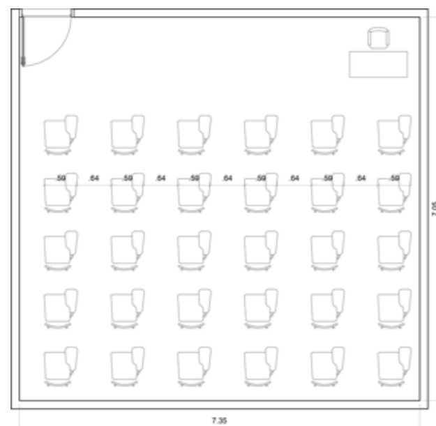
Figura 06: Dimensões recomendadas para salas de aulas teóricas segundo o FNE. Fonte: Memorial descritivo e especificações técnicas (desenho elaborado pela autora, 2020).
