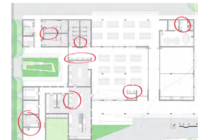
FIGURA 97: Pontos de lavatório na edificação. FONTE: Autora, 2021.
