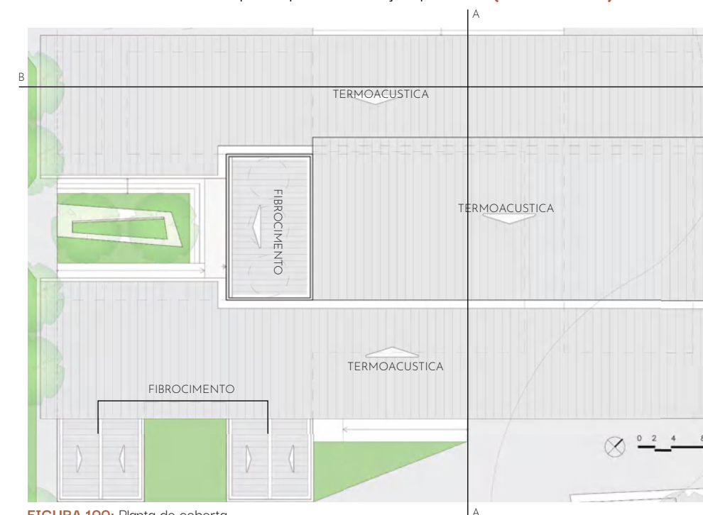
FIGURA 100: Planta de cobertura. FONTE: Autora, 2021.
