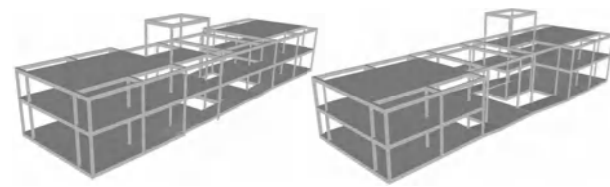
FIGURA 93 – Diagrama de estrutura de lajes, vigas e pilares em concreto. Fonte: Produzido pela autora.
