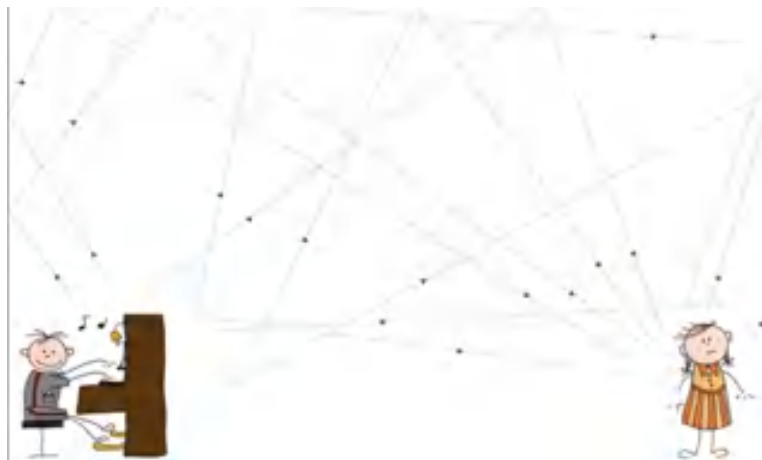
Figura 6.5: Comportamento sonoro em ambiente fechado que gera reverberação.
