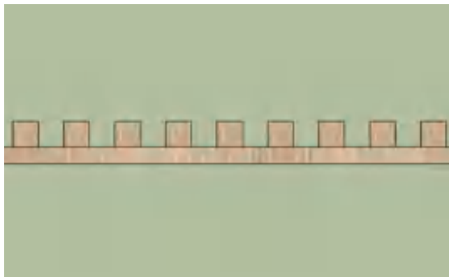
Figura 7.18: Vista superior do difusor utilizado no pavimento superior do templo.
