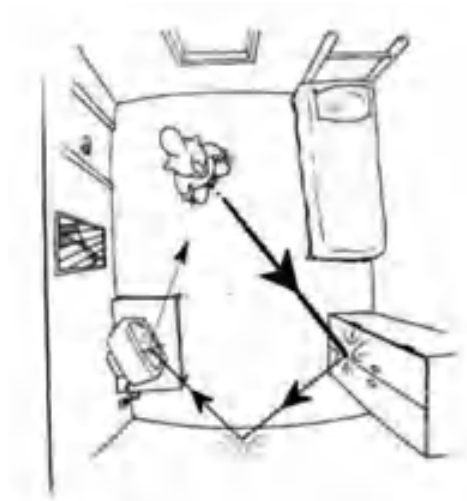
Figura 6.2: Absorção sonora dentro de um ambiente.
