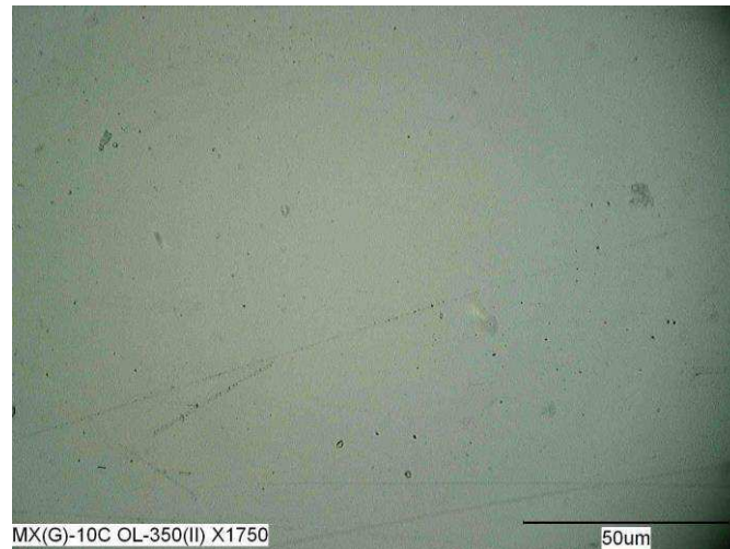
Figura 8: Micrografia óptica da membrana de quitosana pura. Aumento 1750X (AUTOR, 2020).
