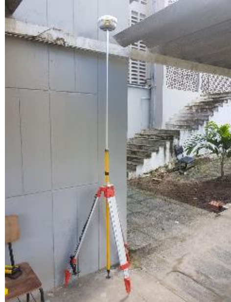
Figura 15: Instalação da base do GNSS geodésico Trimble R4
