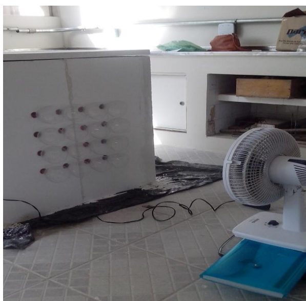
Figura 22: Simulação do vento nas garrafas pets
