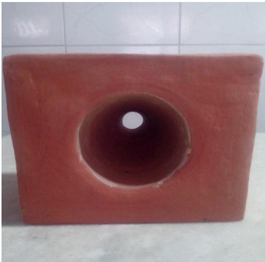
Figura 10: Cobogó em argila) (Vista Frontal)
