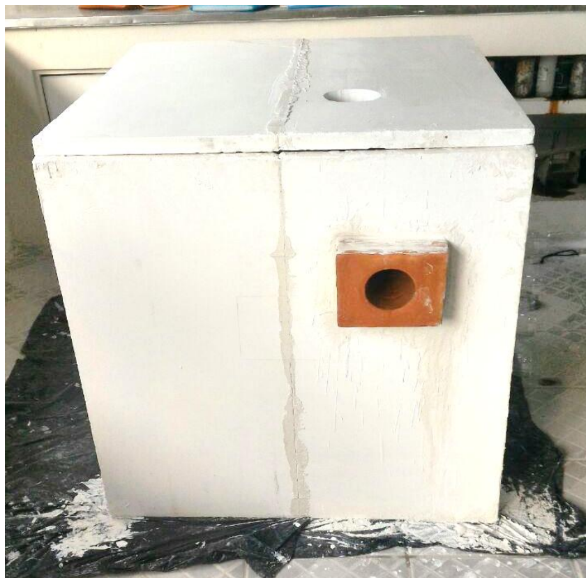
Figura 19: Cobogó acoplado e cubo em gesso coberto
