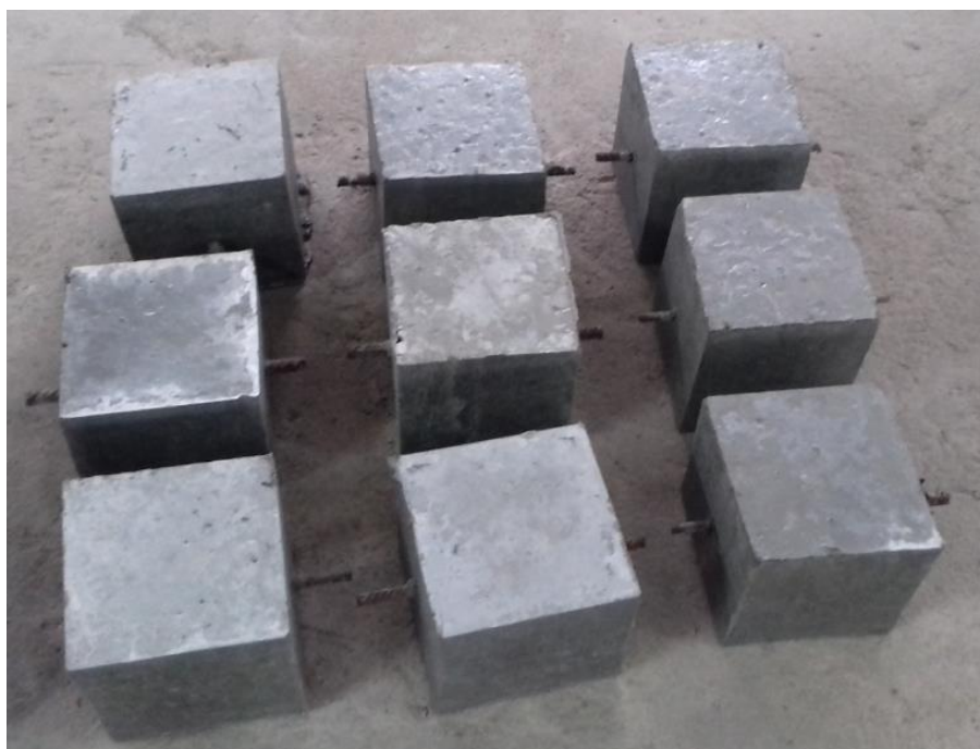
Figura 39 - Corpos-de-prova prismáticos logo após desmoldagem
