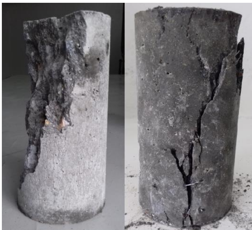
Figura 42 - Corpos-de-prova após ruptura: sem fibra à esquerda e com fibra à direita.
