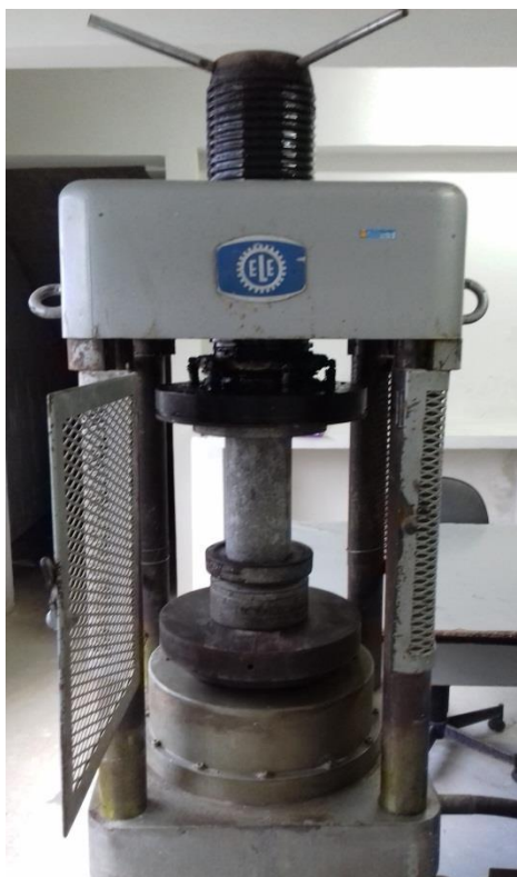
Figura 40 - Ensaio de resistência à compressão
