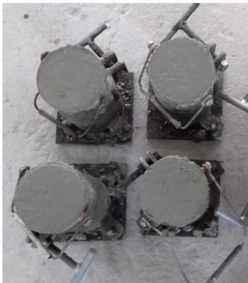
Figura 38 - Corpos-de-prova para ensaio de resistência à compressão
