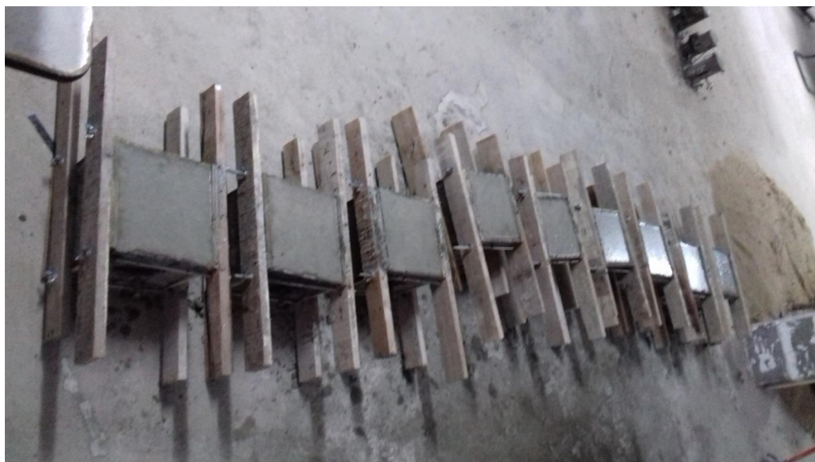
Figura 37 - Corpos-de-prova logo após sua concretagem
