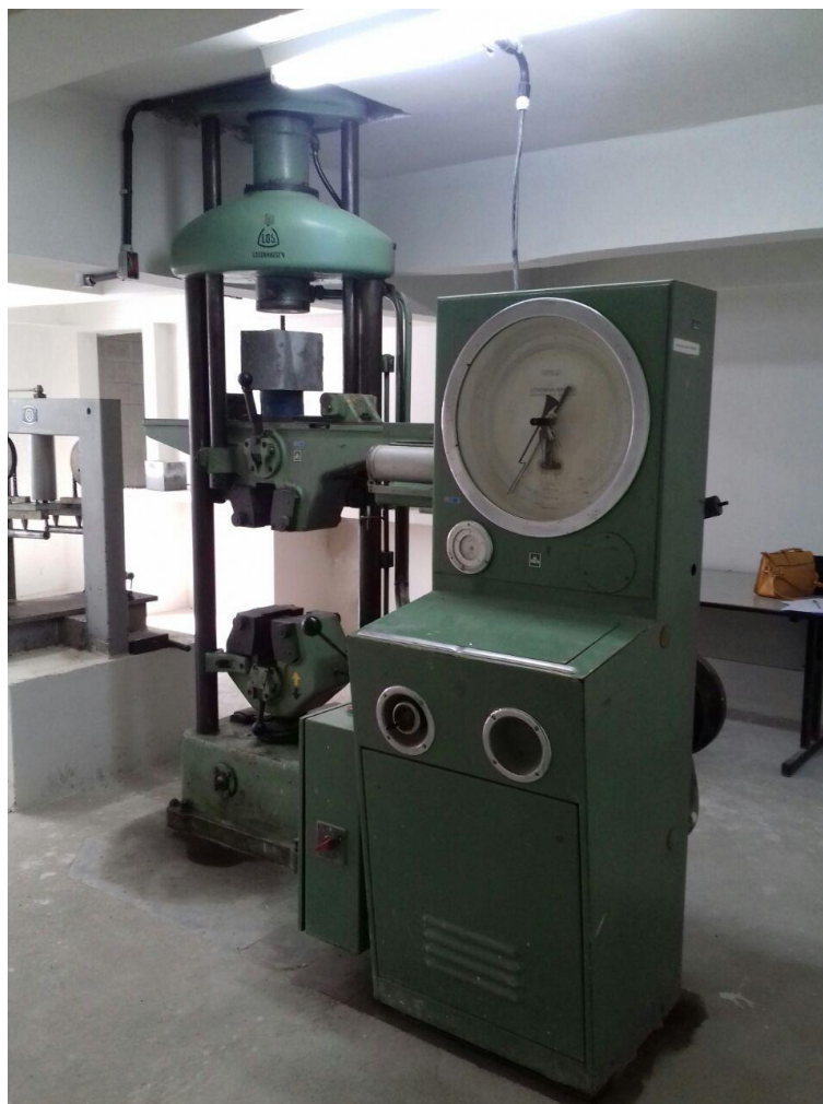
Figura 41 - Realização do ensaio push-out
