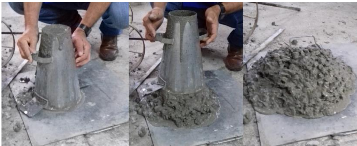
Figura 35 - Ensaio do abatimento do tronco de cone
