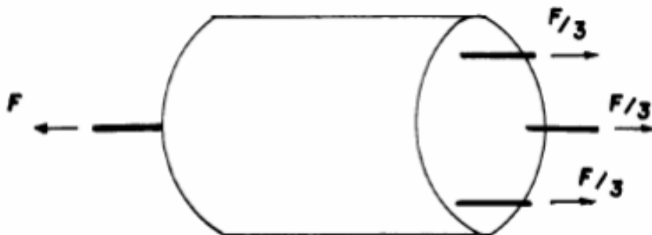
Figura 12 – Esquema do corpo de prova do ensaio das quatro barras.
