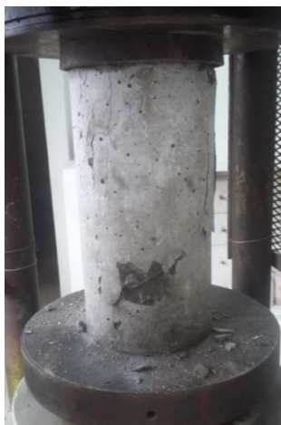
Figura 33 - Ensaio de resistência à compressão.
