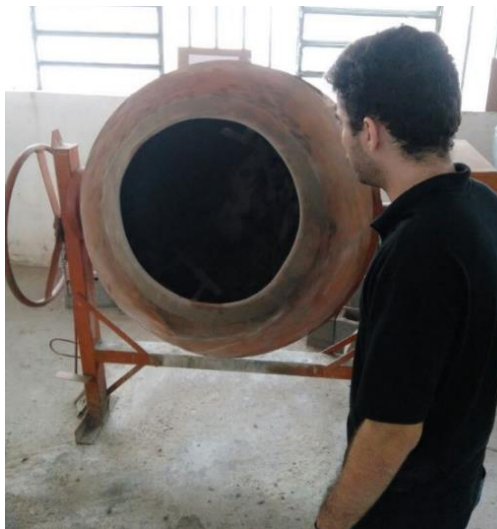
Figura 30 - Mistura do cimento, metacaulim, agregados e fibras de aço.
