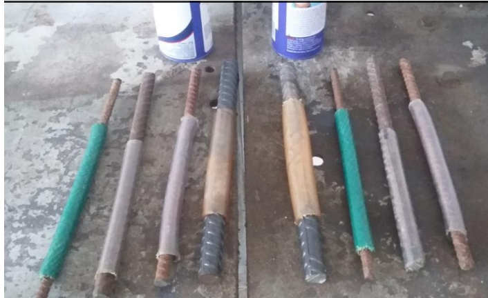
Figura 29 - Uso da mangueira plástica na zona não aderente da barra.
