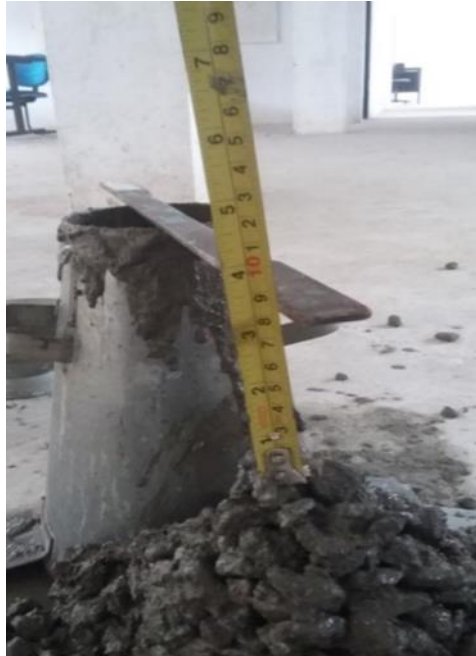
Figura 31 - Ensaio do abatimento do tronco de cone.
