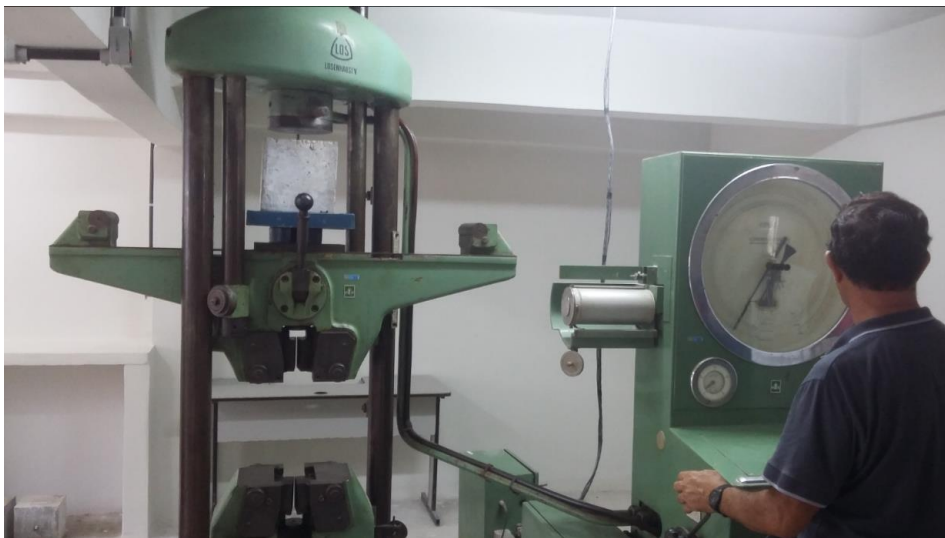
Figura 34 - Ensaio para se obter a tensão de aderência.
