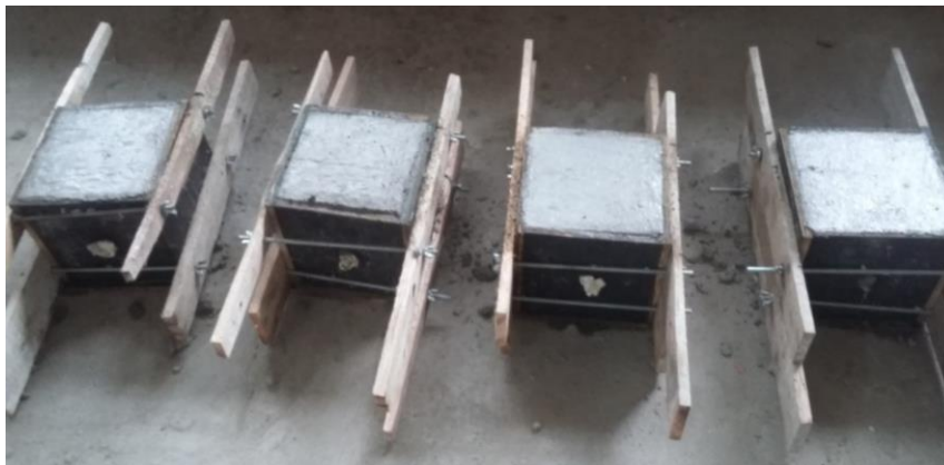
Figura 32 - Moldagem dos corpos de prova.
