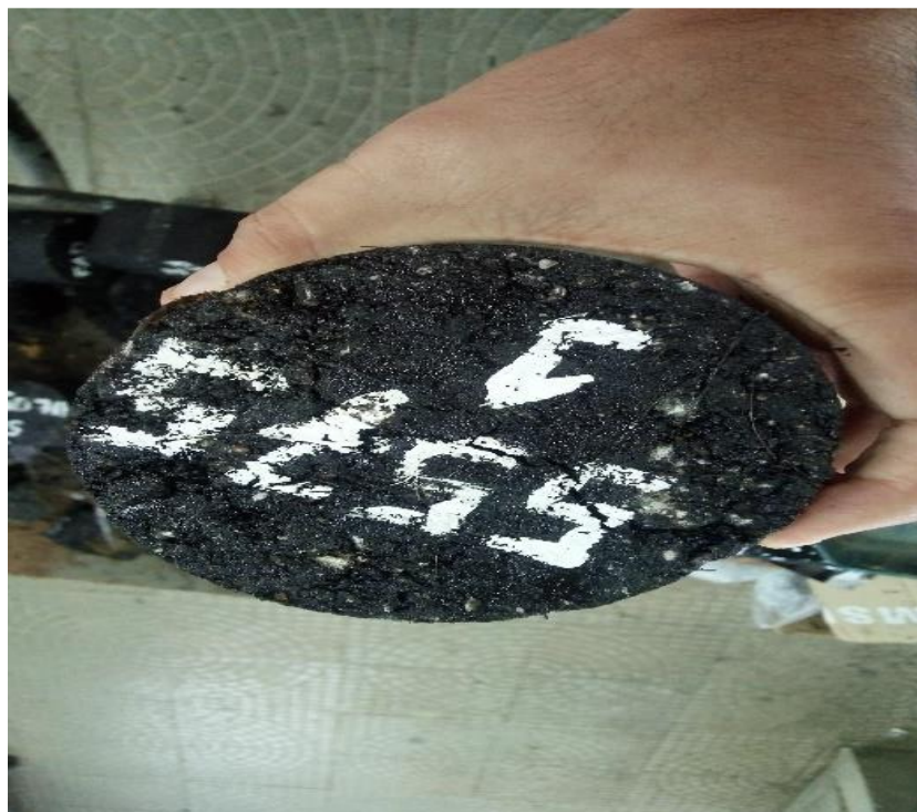
Figura 13 - Corpo de prova rompido
