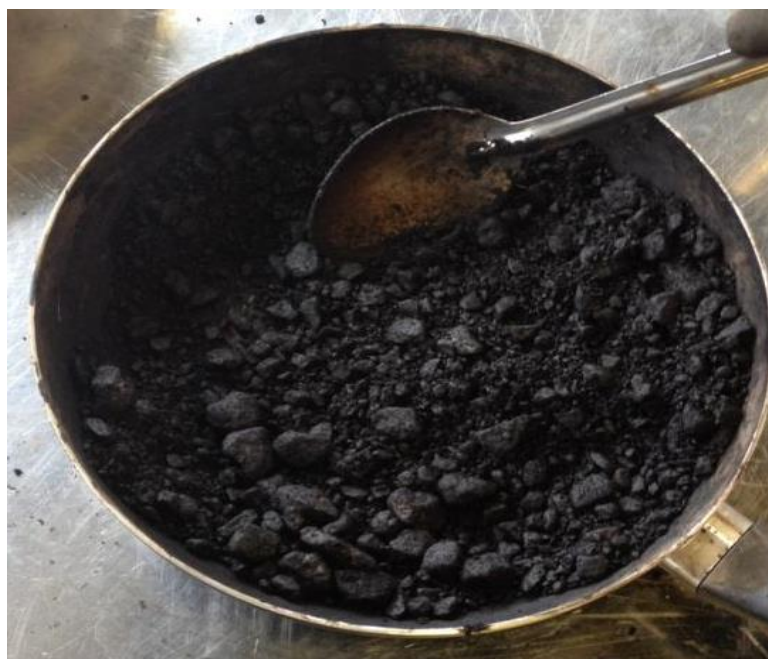
Figura 9 - Mistura do agregado com ligante
