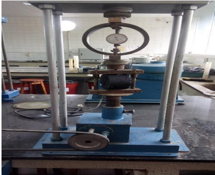
Figura 12: Ensaio de compressão diametral de corpo de prova cilíndrico
