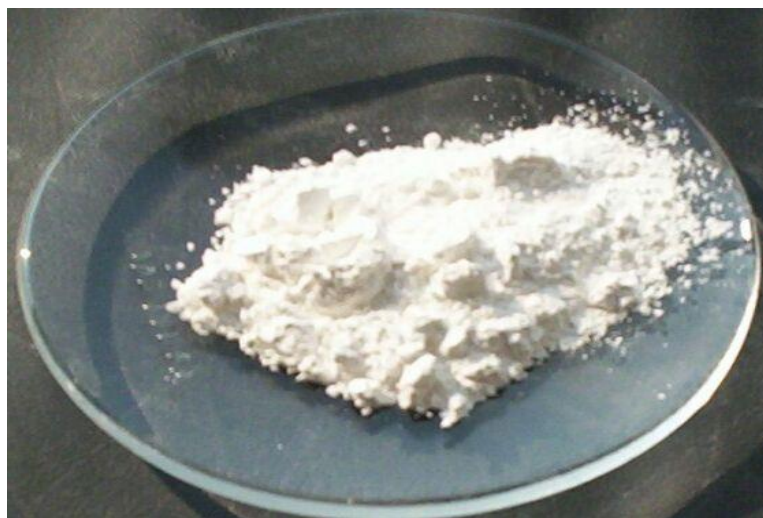
Figura 8 - Filler utilizado (cal hidratada)
