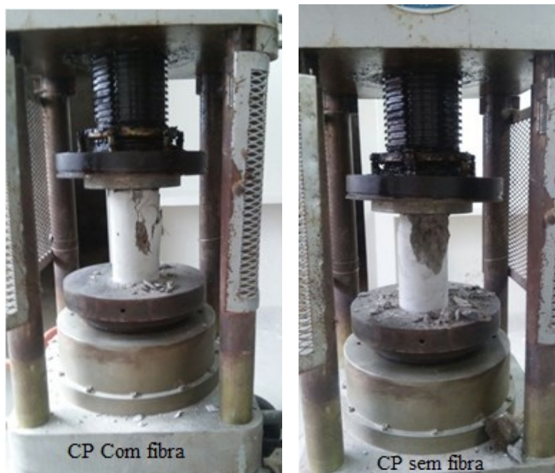
Figura 44: Ruptura dos corpos de prova
