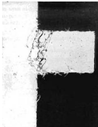
Figura 14: Ruptura por cisalhamento
