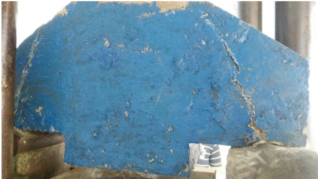
Figura 54: Panorama de progressão de fissuras do modelo M3
