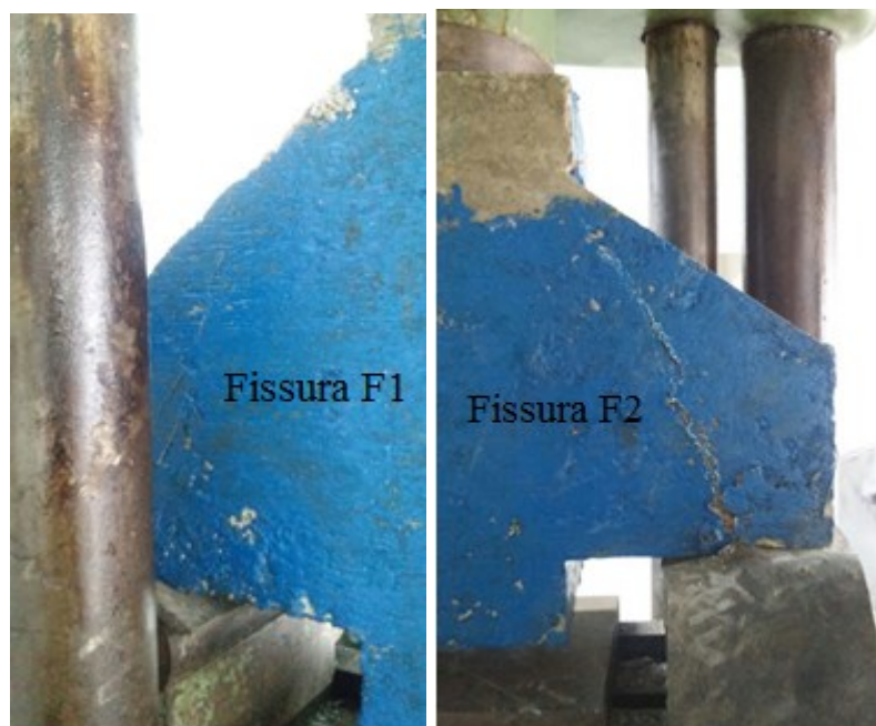
Figura 52: Primeira (F1) e segunda (F2) fissuras do modelo M3
