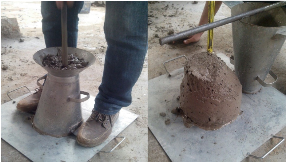
Figura 38: Passo 3 - Determinação do slump test
