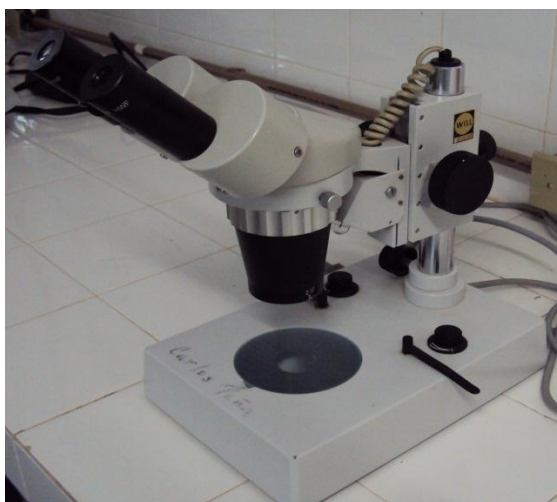
Figura 6- Lupa estereomicroscópica para visualização dos oócitos de cadelas e gatas submetidas a OSH no HV/CSTR- UFCG
