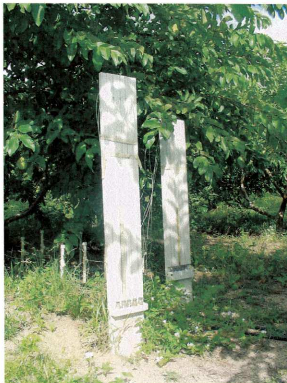
Figura 3.5. Baterias de tensiômetros instaladas sob a copa da goiabeira.
