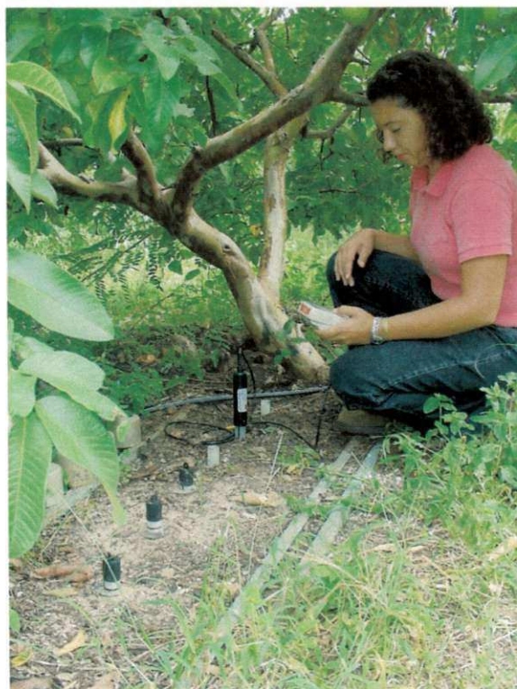
Figura 3.6. Tubos de acesso para medida da umidade do solo sob a copa da goiabeira.
