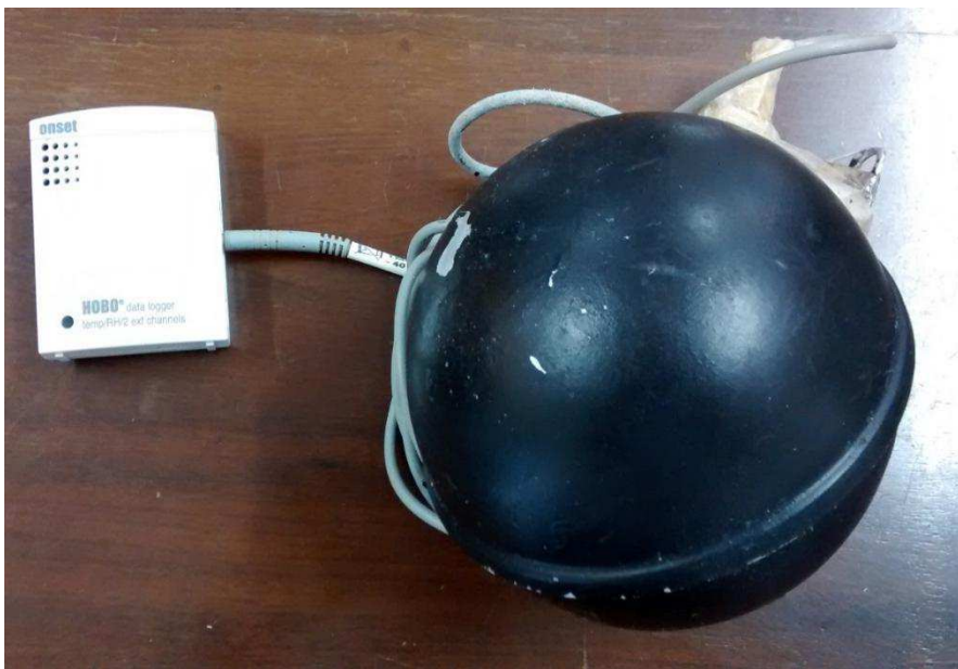
Figura 4: Datalogger tipo hobo com cabo externo acoplado ao globo negro
