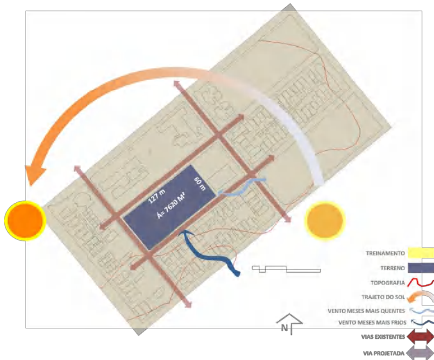
Figura 22 Iluminação e ventilação
