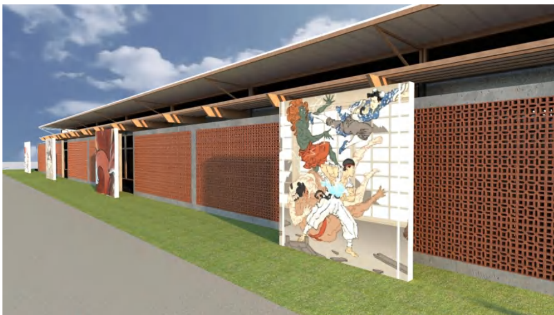
Figura 57 Vista dos panos de cobogó e painéis artísticos.
