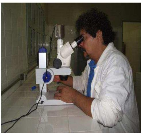
**Figura 5:** Conteúdo Recuperado e Avaliação no Estereomicroscópio Zeiss, modelo Stemi 2000-C, com aumento de 10 X.
