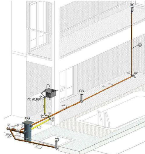
2 ISOMÉTRICO ESGOTO SANITÁRIO COZINHA
