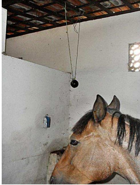
**FIGURA 6:** Globo negro com sensor térmico e datalogger no interior das de baias. Fonte: Arquivo pessoal.
