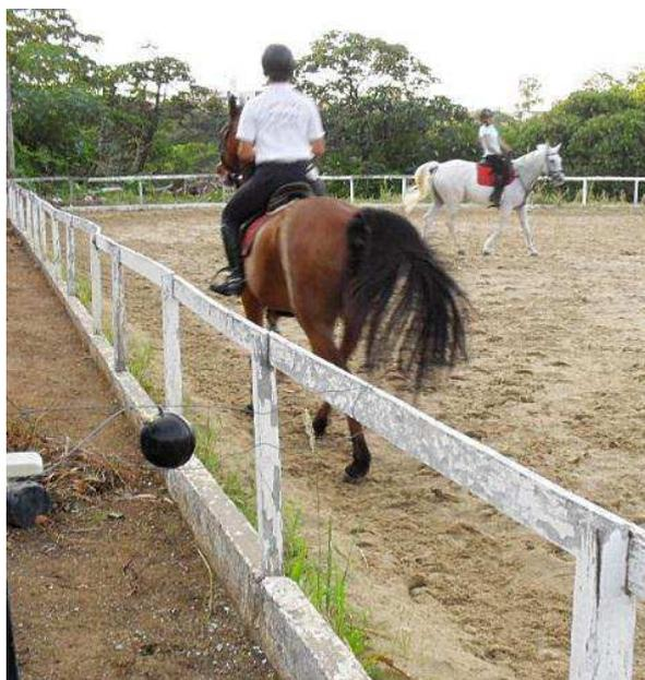
**FIGURA 5:** Globo negro com sensor térmico e datalogger no local treinamento dos animais. Fonte: Arquivo pessoal.
