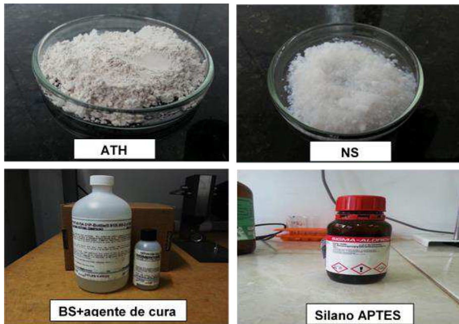
Figura 9 - Materiais utilizados na obtenção dos revestimentos: a) ATH; b) NS; c) BS + agente de cura; d) agente de acoplamento silano (APTES).
