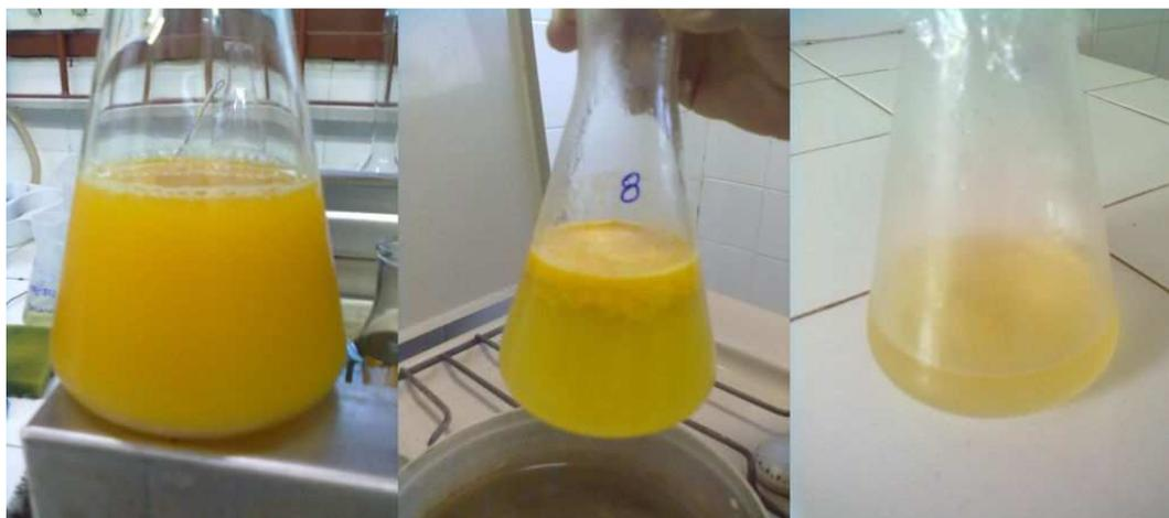
Figura 49 - Aplicação do extrato enzimático bruto no suco de maracujá: suco *in natura*, suco após tempo de contato com a enzima e suco filtrado (da esquerda para a direita)
