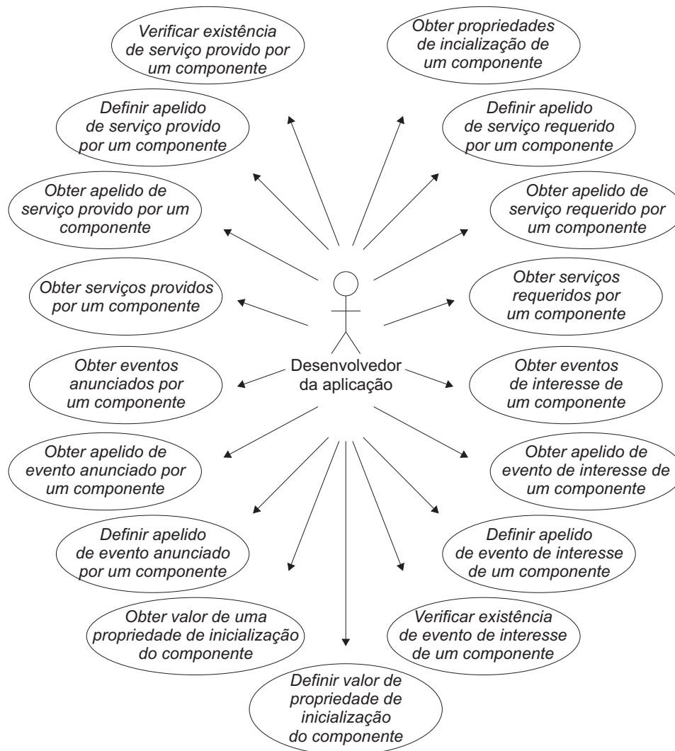
Figura A.4: Diagrama de casos de uso relacionados ao desenvolvimento de aplicações, com foco em parametrização de componentes.
