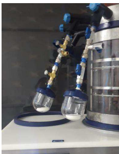
Figura 5: Amostras no liofilizador para obtenção da cinética. Fonte: Autora (2021).
