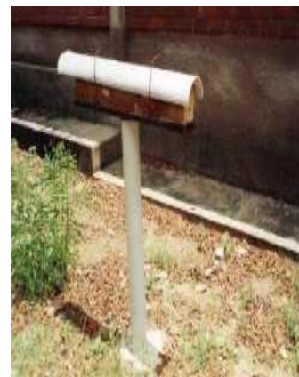
Fig.5 Caixa modelo UFPB, em grade sob suporte de PVC 150 com telhado.
