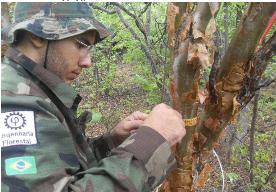
Figura 6 — Medição de circunferência dos indivíduos amostrados com auxílio de fita métrica
