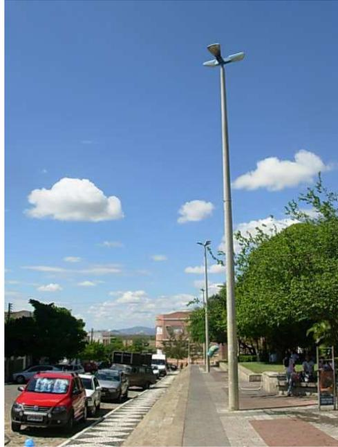
**Figura 9.** Poste em concreto com luminárias em três pétalas.
