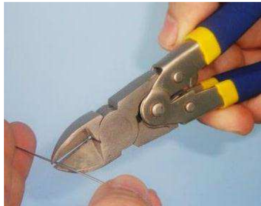
Figura 6: Corte das amostras (28 mm da parte mais reta do arco - extremidade) (Fonte própria).
