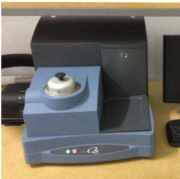
Figura 12: Equipamento de DSC da TA Instruments ® modelo Q-20 (New Castle, USA) (Fonte própria).
