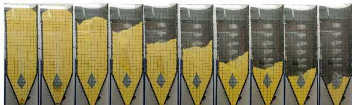
Figura 43 - Características de fluxo da farinha de milho flocada para o insert 2 invertido na altura 1, armazenado por 24 horas.
