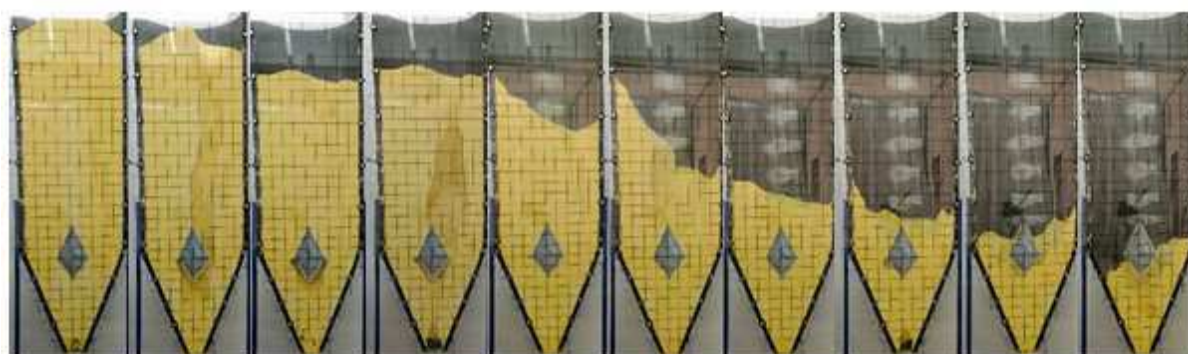
Figura 45 - Características de fluxo da farinha de milho para o insert 2 invertido na altura 2, armazenado por 24 horas.
