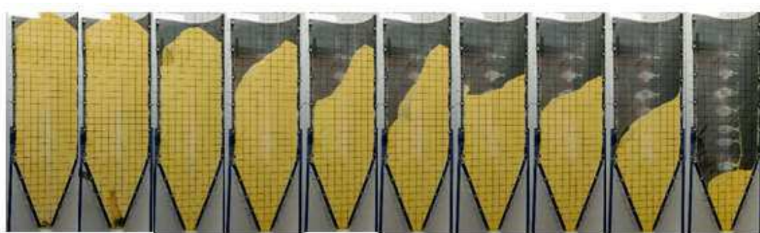
Figura 23 - Características de fluxo da farinha de milho sem insert, armazenado por 24 horas.
