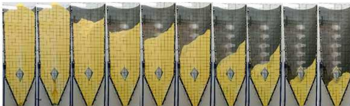
Figura 41 - Características de fluxo da farinha de milho para o insert 2 na altura 3, armazenado por 24 horas.
