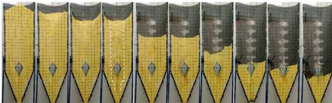
Figura 40 - Características de fluxo da farinha de milho para o insert 2 na altura 3, instantâneo.
