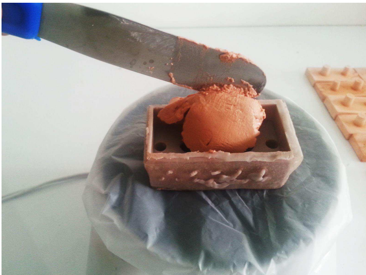
Figura 7 - Vazamento de modelos com auxílio de vibrador de gesso.
