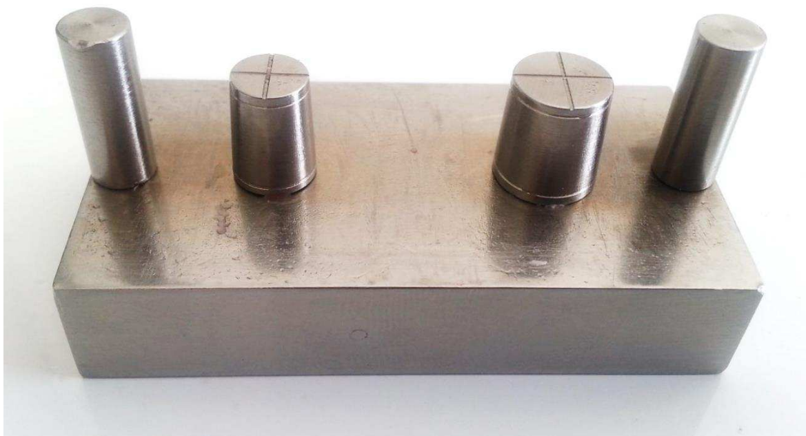
Figura 1 - Matriz metálica utilizada para comparação das análises dimensionais dos grupos.
