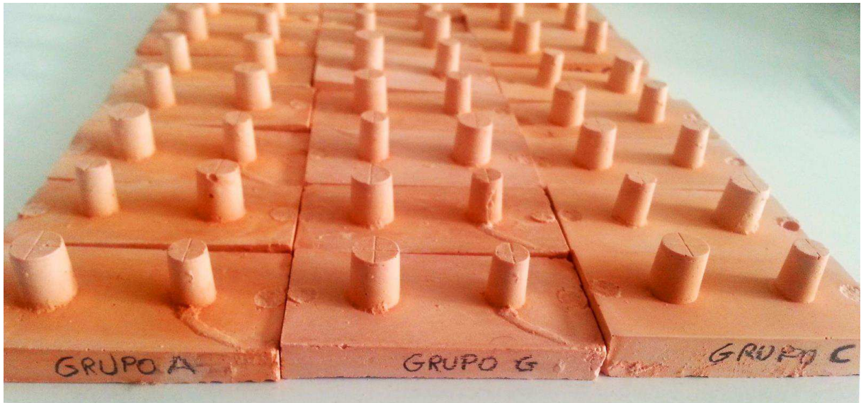
Figura 8 - Corpos de prova identificados por grupos.
