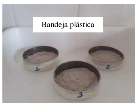
Figura 33 - Teste para a Determinação do CRA do SAT
