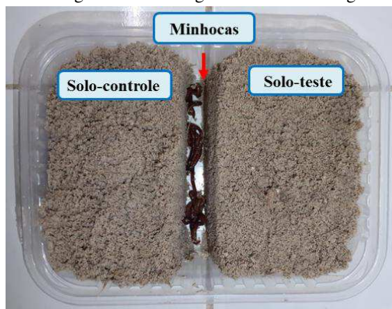
Figura 39 - Montagem do Ensaio de fuga
