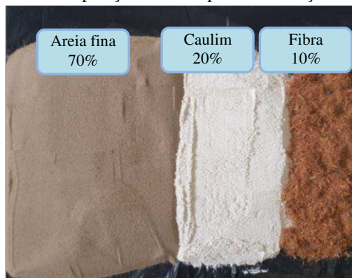
Figura 31 - Composição do SAT para a realização dos testes
