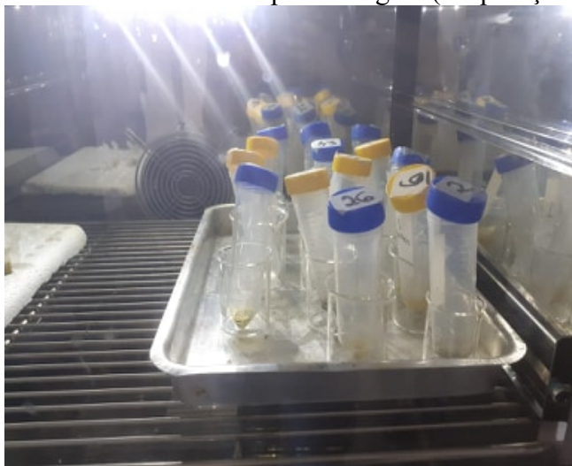
Fotografia 4 - Amostras em tubos cônicos para secagem (evaporação do solvente) a 27°C.
