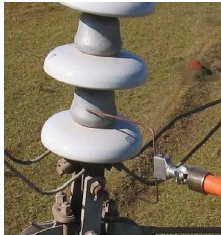
Figura 5.4 – Garfo para teste de ruído. Foto CIGRÉ, 2008
