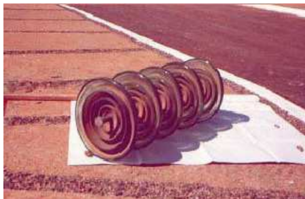
Figura 3.28 – Cadeia de isoladores poluídas. Foto CIGRÉ 2008
