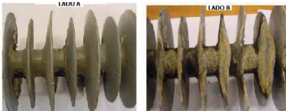
Figura 3.34 – Isolador polimérico que sofreu arco de potência. Foto CIGRÉ 2008.
