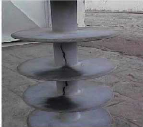
Figura 3.36– Isolador polimérico falha de fabricação. Foto CIGRÉ 2008.
