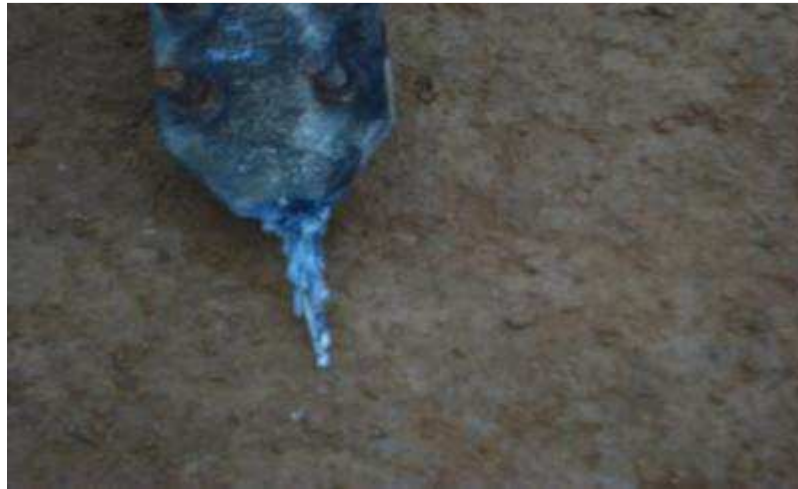
Figura 3.47 – Rompimento de cabo por descarga atmosférica. Foto Chesf Josué
