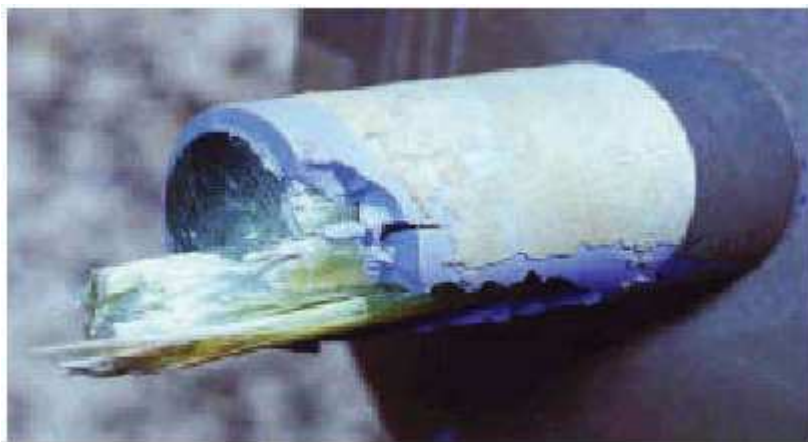
Figura 3.38– Isolador polimérico rompimento por fratura frágil Foto CIGRÉ 2008.
