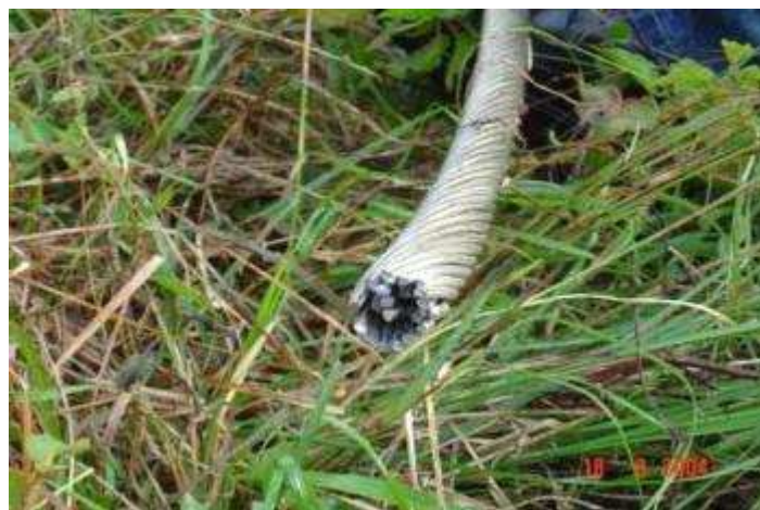
Figura 3.49– Rompimento de tento por vibração eólica. Foto Chesf Josué
