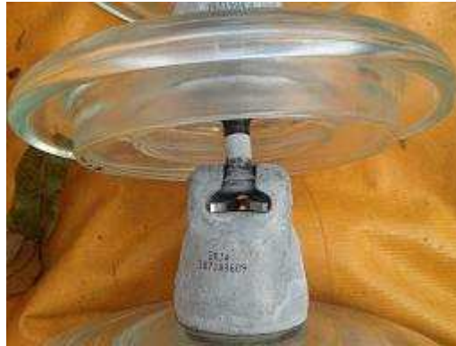
Figura 3.25 – Isolador de vidro. Foto Chesf Antonio Carlos.
