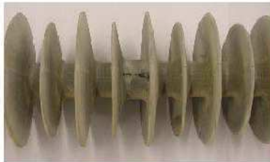
Figura 3.32 – Isolador polimérico com núcleo exposto. Foto CIGRÉ 2008.
