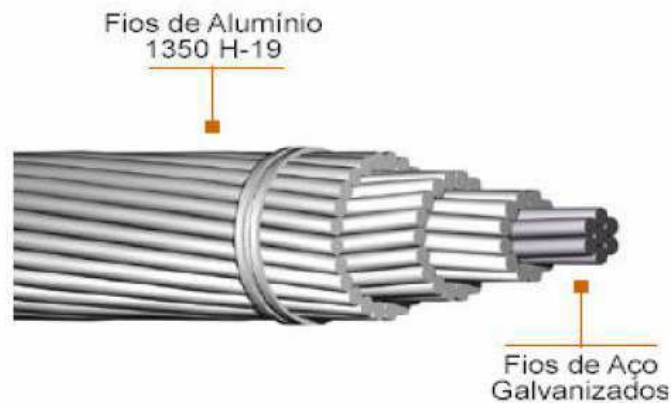
Figura 3.41 – Cabos de alumínio com alma de aço. Fonte COSTA, 2009
