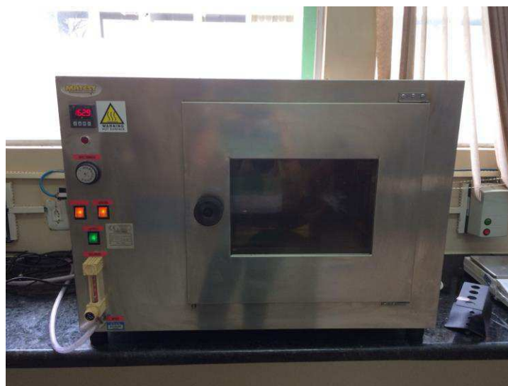
Figura 14: Estufa para procedimento RTFO.
