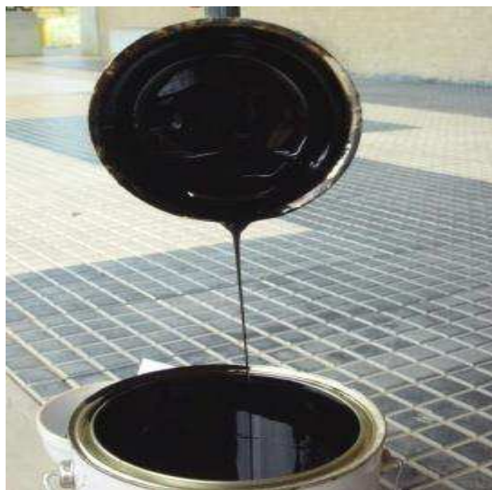
Figura 5: Cimento asfáltico de petróleo (CAP).
