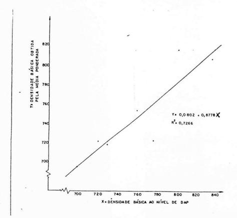
FIGURA 3. Correlação entre a densidade básica do disco obtido ao nível do DAF e a representada pela média ponderada.
