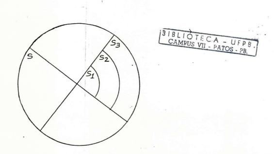
FIGURA 1. Local no disco onde foram retiradas as amostras para o estudo da densidade básica e de sua variação longitudinal (S) e radial (S1, S2 e S3).
