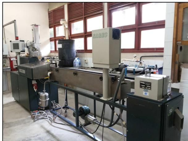
Na Tabela 3 estão apresentadas as temperaturas para cada zona de aquecimento, a velocidade de rotação da rosca e taxa de alimentação. O material resultante foi granulado logo após sua extrusão e seco em estufa sob vácuo a 40°C por 24h. Na Figura 17 está ilustrado o perfil da rosca utilizado na extrusão dos materiais.
