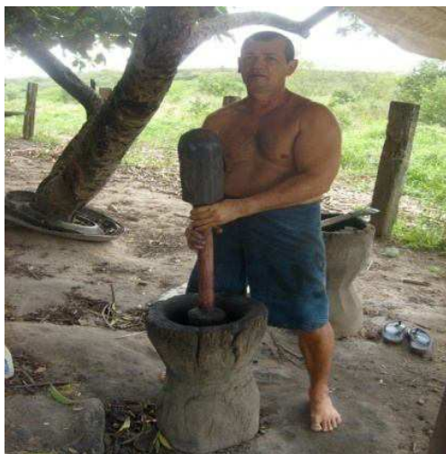
Foto 8 - Pilão usado na fabricação da pólvora (Fonte: Bárbara Santos)
