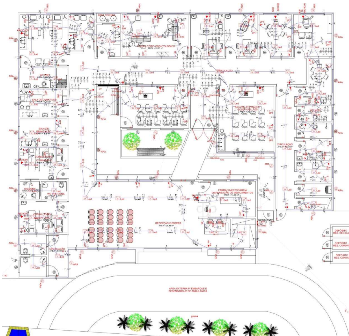
Figura 28 – Planta baixa do projeto elétrico original
