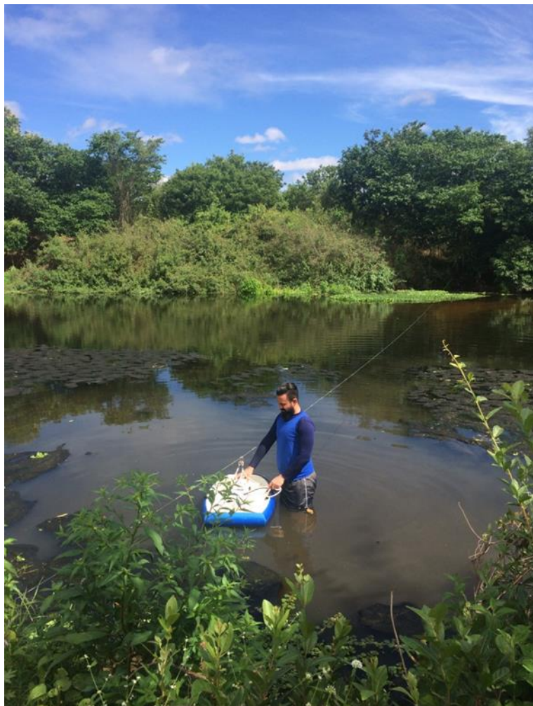
Figura 13 – ADCP instalado na prancha momentos antes de começar a coleta de dados
