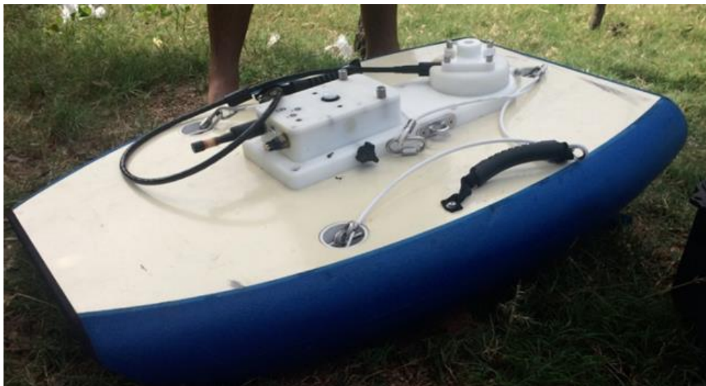
Figura 15 – Prancha HydroBoard I com o ADCP antes da travessia
