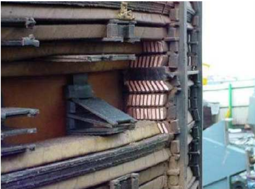
Figura 19 – Efeito tilting em um transformador real. (CHESF/UFU, 2009).
