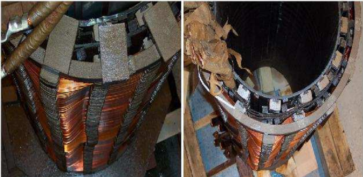
Figura 12 – Saliências causadas por compressões radiais - free buckling. Modificado de (Rosentino, 2010).
