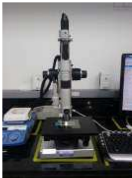
Figura 8: Microscópio Óptico Digital Hirox Modelo KH-1300, de reflexão e transmissão, com canhão MX(G)2016Z.
