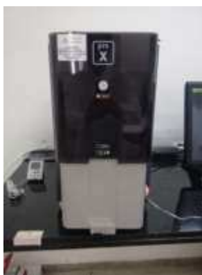
Figura 9: Microscópio eletrônico de varredura modelo Phenom Pro X.
