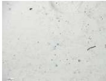
Figura 12: Microscopia ótica das MQ no aumento de 80x, evidenciando a não presença de poros visíveis.
