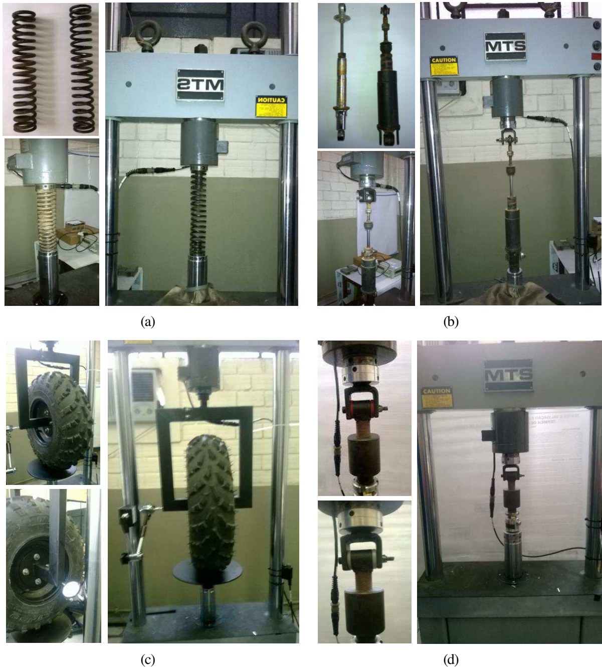
Figura 51: Componentes e sua montagem na MTS: (a) mola; (b) amortecedor; (c) pneu; (d) bucha.
