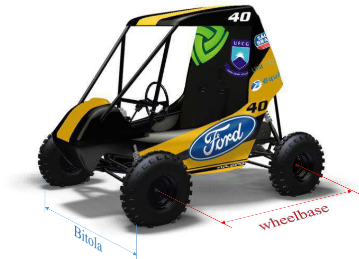
Figura 26: Bitola e wheelbase do baja UFCG 2012.
