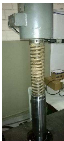
Figura 11: Ensaio de compressão em mola helicoidal usando MTS.
