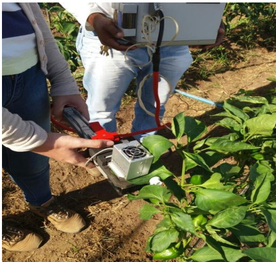
Figura 3. Avaliação de trocas gasosas com auxílio do analisador de gás por infravermelho (IRGA) modelo LCPro + . Pombal, PB. 2017.
