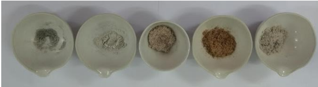
Figura 3: Material triturado após a queima na mufla a 600°C. Da esquerda para a direita: catingueira, jurema preta, capim panasco, capim arroz e capim digitária.
