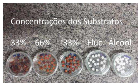
Figura 7 Discos do extrato hidroalcoólico de própolis preta nas concentrações de 26,4 mg/mL (33%), 52,8 mg/mL (66%) e 79,2 mg/mL (99%), e do fluconazol na concentração de 25 mg/mL e do álcool etílico a 70%, respectivamente.
