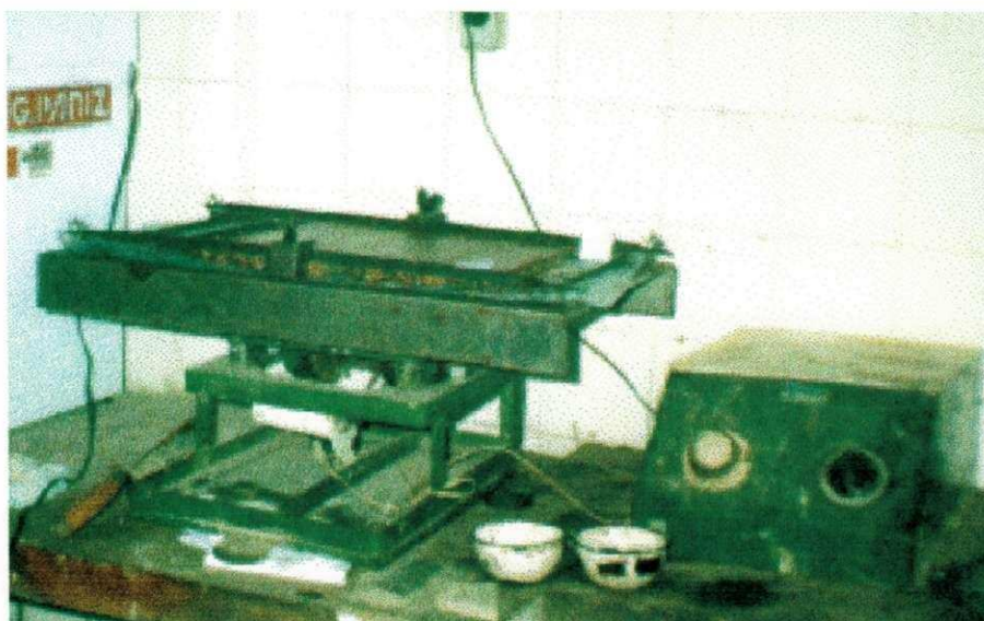
FIGURA 3.6 – Corpos-de-prova na mesa vibratória
