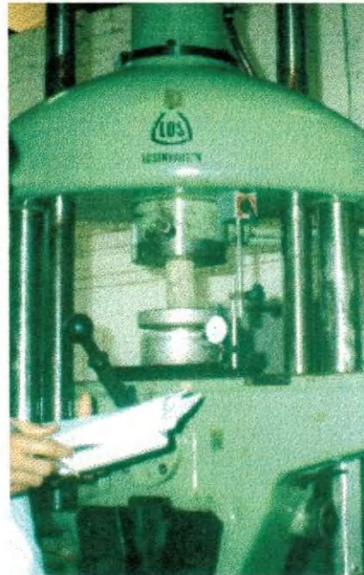
FIGURA 3.2 – Prensa LOSENHOUSI'V usada no ensaio de compressão curadas em água
