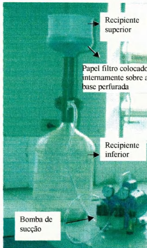
FIGURA 3.14 – Equipamento utilizado para retirar, por sucção, a água da mistura
