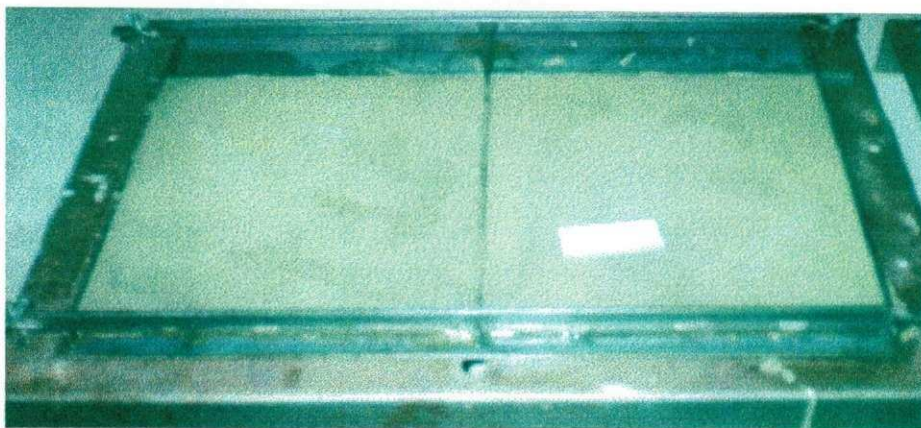
FIGURA 3.8 –Moldes e corpos-de-prova utilizados no ensaio de condutividade térmica.
