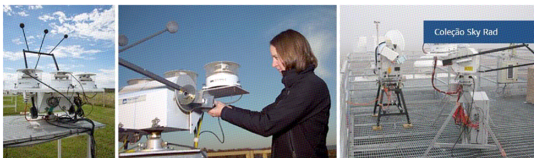
Figura 9 – Radiômetros celestes em suporte para radiação descendente da coleção que o ARM denomina de SKYRAD.
